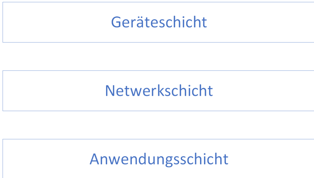
Abbildung 2 Dreischichtiges IoT-Architekturmodell [3, p. 101, 8, p. 475]
